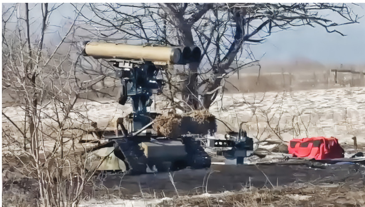
НРТК «Варан» з протитанковим комплексом «Корнет»
